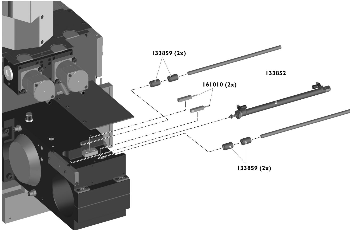
**Schleifkopf Innenschleifen HF   Poupée porte-meule rectification intérieure HF   Wheelhead I.D. grinding HF**
