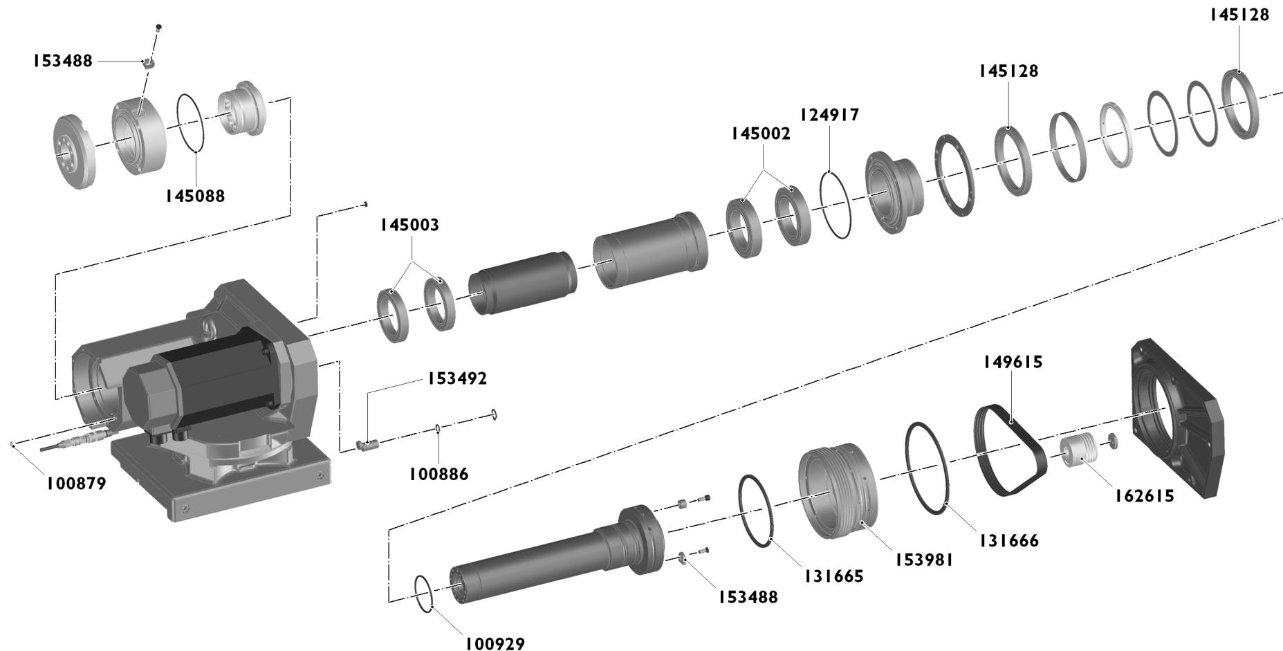
**Werkstückspindelstock mit orientierter Spindelhalt**   **Poupée porte-pièce avec arrêt orienté de la broche porte-pièce**   **Workhead with positioned spindle stop**
