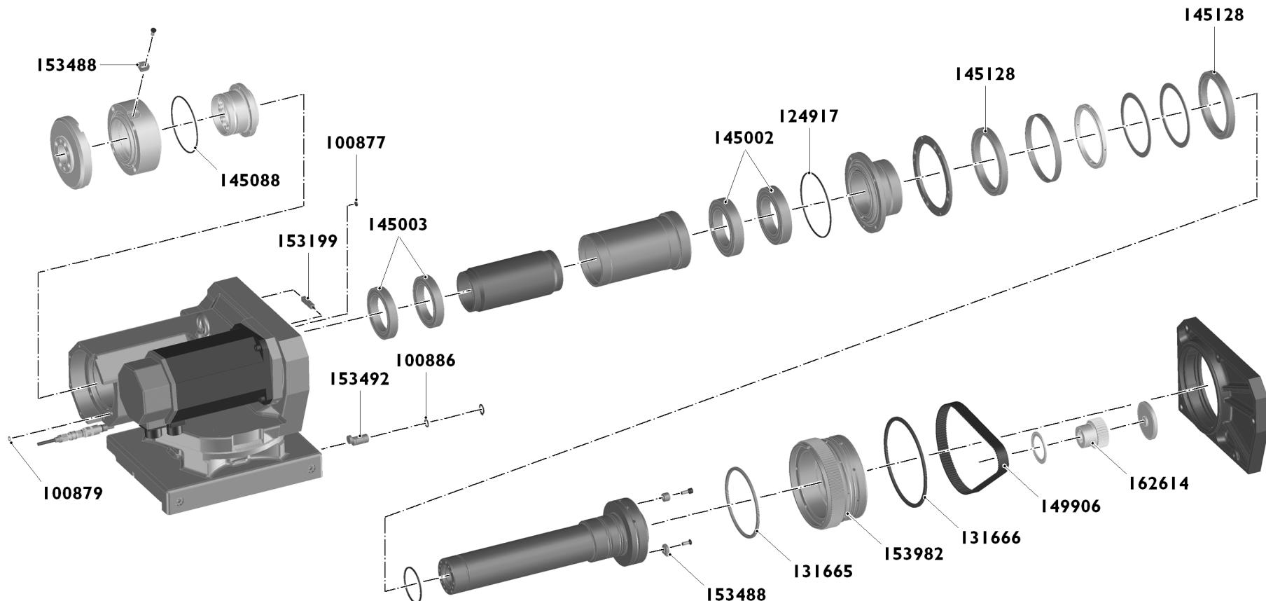
**Werkstückspindelstock mit C-Achse   Poupée porte-pièce avec axe-C   Workhead with C-axis**
